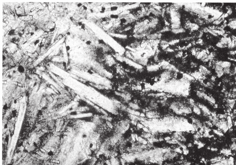
図3. 反応リム部と中心部境界の偏光顕微鏡写真(オプティカル)
