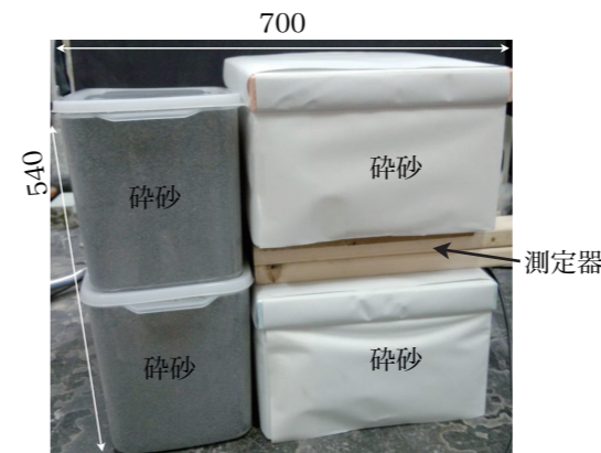
写真4(b) 砕砂による囲み法 (単位: mm)
