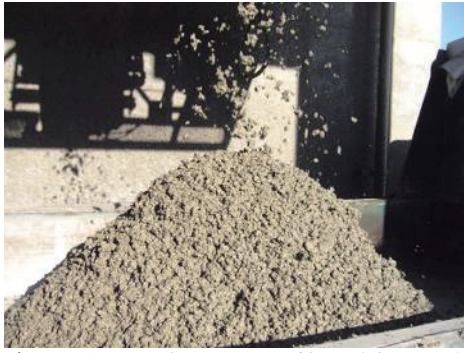
写真2 生コンプラントでの練混ぜ直後の様子
