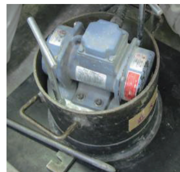
写真1 上面振動締固め試験の様子
