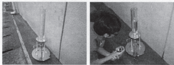
写真3 現場透水量試験器および測定状況
