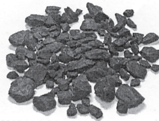
写真-2 再生粗骨材
